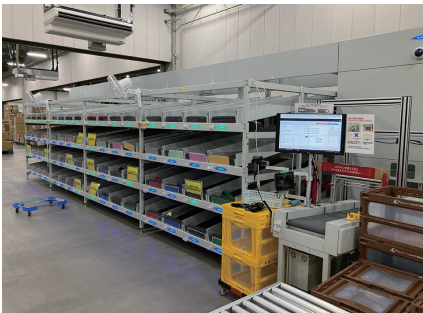
医療機関が必要とする多品目の医療材料・医薬品・医療機器の流通・管理を基盤に、経営をサポートしている。右は、倉庫内の機械化に取り組む中で導入した、自動仕分けロボット「オムニソーター」
